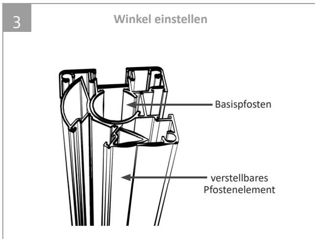
3 | Verstellbares Pfosten-Element in die gewünschte Position drehen.
