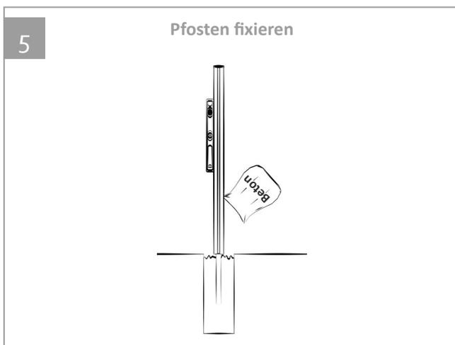
5 | Das Erdloch komplett mit Beton füllen und verdichten.
