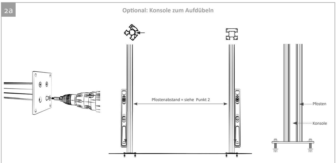
2a | Konsolen auf die Pfosten stecken und mit den mitgelieferten Schrauben von unten fest verschrauben. Ausrichtung der Konsolen bei aufgesteckten Pfosten, danach auf den Untergrund aufdübeln.
