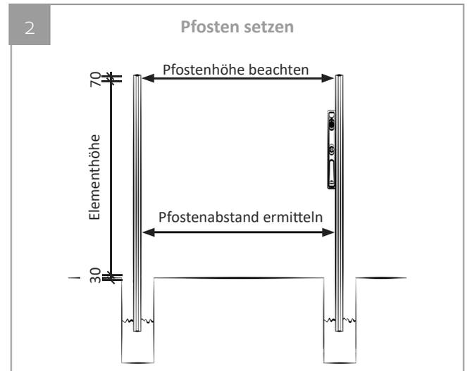
2 | Anschließend die Pfosten setzen und ausrichten.
