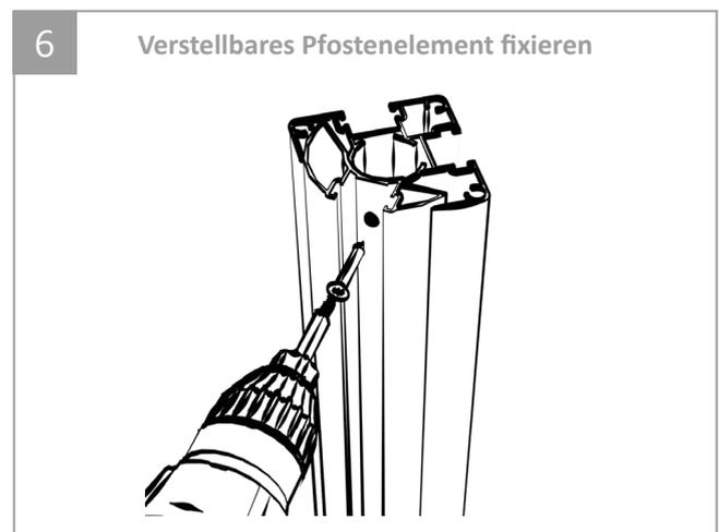
6 | Den Basispfosten am verstellbaren Pfosten-Element mit der mitgelieferten Schraube fixieren.
