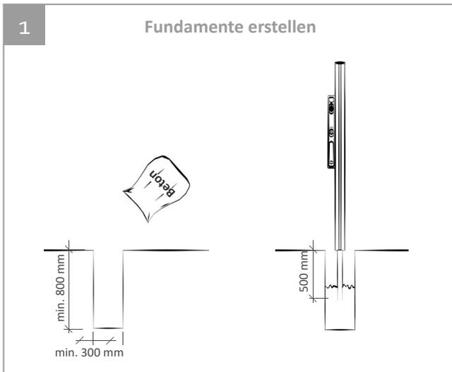
1 | Größe der Fundamente mindestens 300 x 300 x 800 mm sowie unter Berücksichtigung der Bodenbeschaffenheit.\* Ungefähr die Hälfte des Erdloches mit Beton füllen und verdichten.
