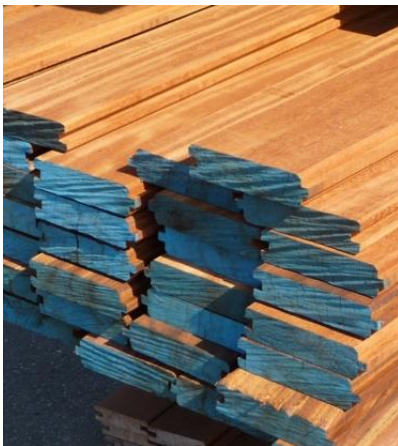
Werkseitig aufgetragener Hirnholzschutz
